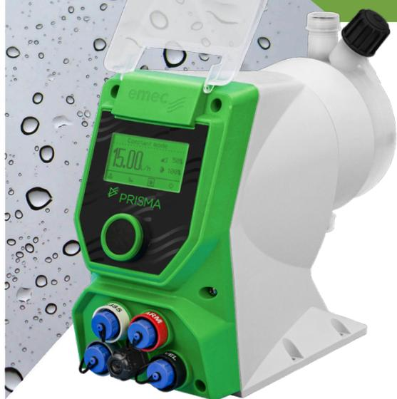
La pompe doseuse à diaphragme et moteur pas à pas PRISMA est conçue pour des applications qui nécessitent des volumes de dosage de haute précision et une répétabilité fiable. Grâce au moteur pas à pas contrôlé par un microprocesseur et à l'excellente résolution de pas à 1 : 4800, l'ensemble du cycle de course et d'aspiration est contrôlé avec une précision maximale. Fréquence maximale de course: 180 St/m.
